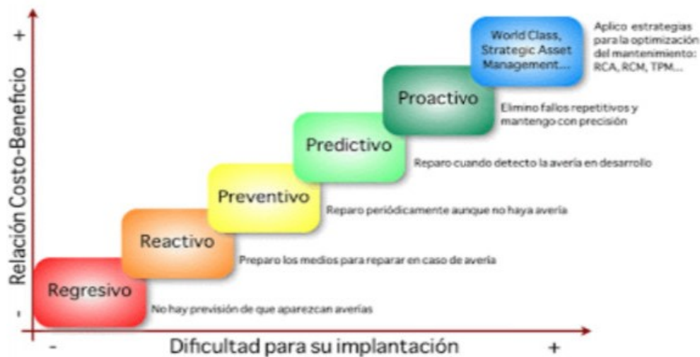
Figura 14. Clasificación de las estrategias de mantenimiento en función de su relación costo-beneficio y de la dificultad para su implantación.
