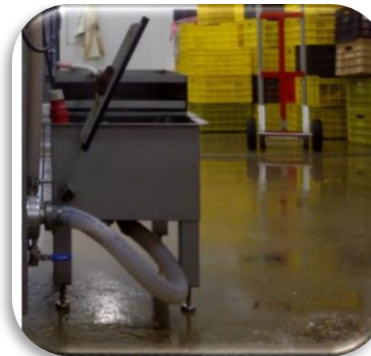
Figura 9 Tanque de Salmuera
