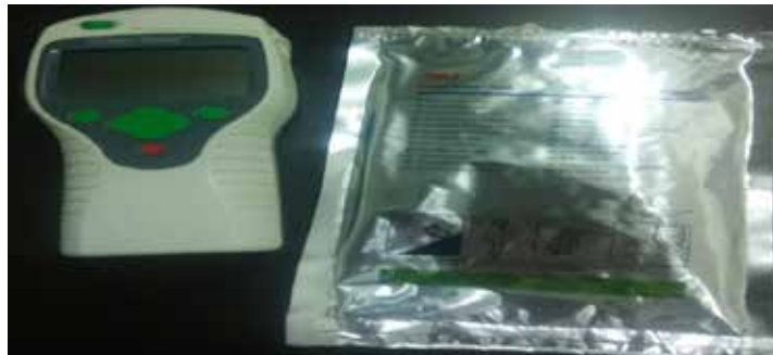
Figura 7: Equipo Luminómetro 3M Clean Trace de Agua- ATP libre
