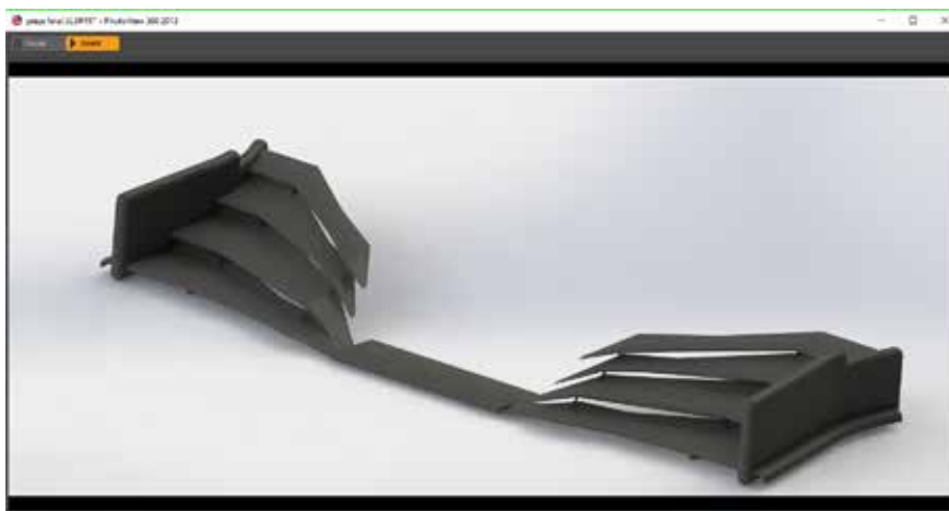
Figura 60. Versión final del alerón delantero en diseño.
