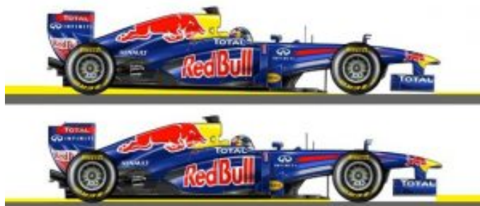
Figura 14. Variación del rake en un monoplaza de fórmula 1.
