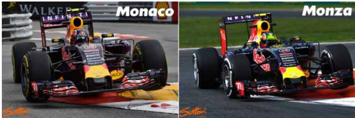
Figura 16. Comparativa de los reglajes aerodinámicos del alerón delantero de un monoplaza de la escudería Red Bull en los autódromos del gran premio de Monaco y Monza.
