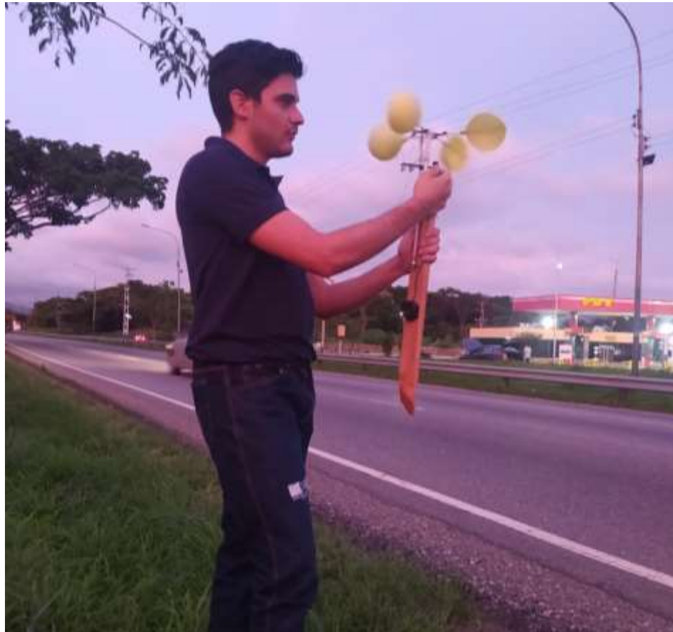
Figura 23 Proceso de medición de la velocidad del viento producidos por le vehiculos que transitan por la autopista Barbula-Guacara
