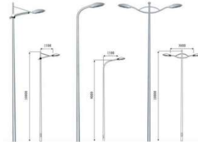
Figura 17 Postes de Alumbrado Público
