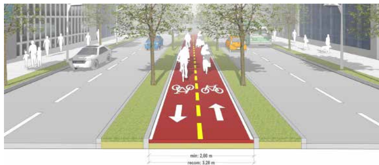
Figura 4. Ejemplo esquemático de ciclovía (bidireccional) en separador central.
