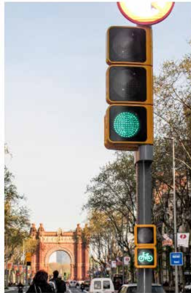
Figura 13. Semáforo para bicicletas adosado al semáforo vehicular
