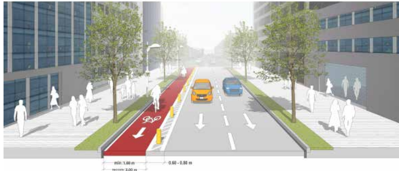
Figura 3. Ejemplo esquemático de ciclovía unidireccional
