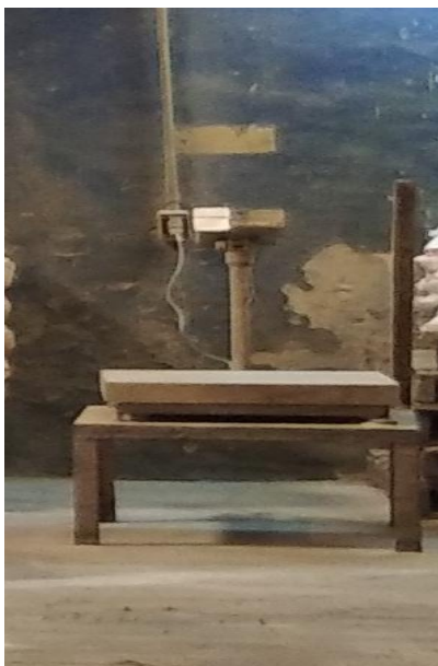
Figura N° 8 Balanza utilizada para la elaboración de micro ingredientes AUTOR: VARGAS, M. (2021)
