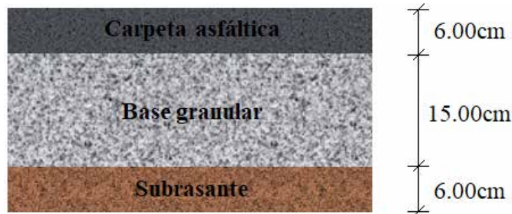
Figura 32: Despiece de la estructura de pavimento dimensionada.
