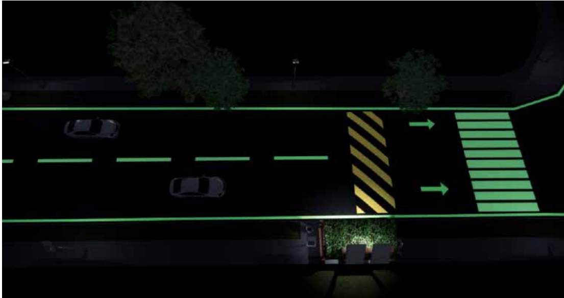
Figura 91: Demarcación con la Pintura fotoluminiscente Fuente: Cuenca C. (2021).
