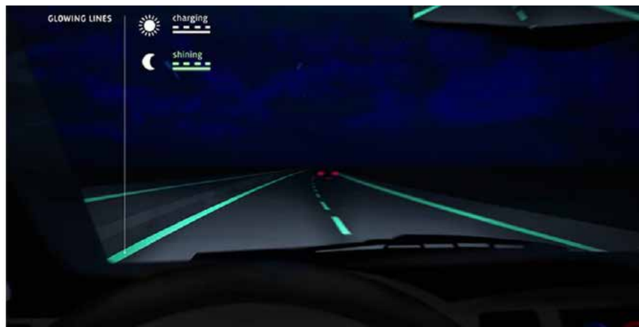
Figura 73: Demarcación con pintura fotoluminiscente.
