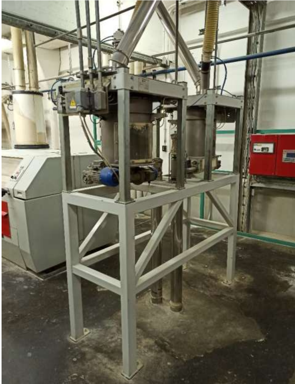
Gráfico 8: Sistema de dosificación de aditivos.
