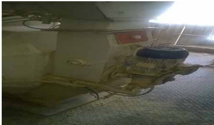
Figura.33. motor forzador de la maquina peletizadora de la empresa Alimentos lagunita Carabobo
