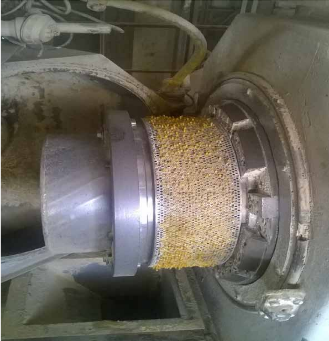
Figura.34. molde de la maquina peletizadora de la empresa Alimentos lagunita Carabobo
