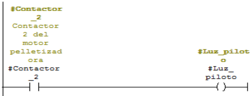
Figura 50. Luz piloto de arranque del motor de la maquina peletizadora
