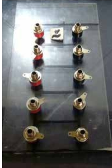
Figura 60. Etapa del montaje de las borneras Fuente: Leung y Sandoval (2017)
