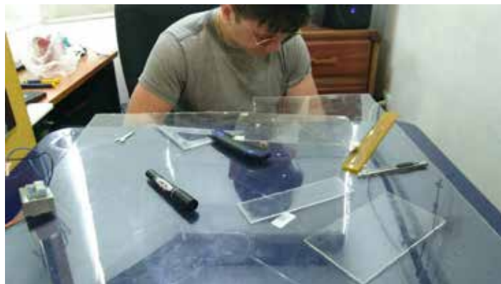
Figura 57. Etapa del corte de la lámina de acrílico Fuente: Leung y Sandoval (2017)
