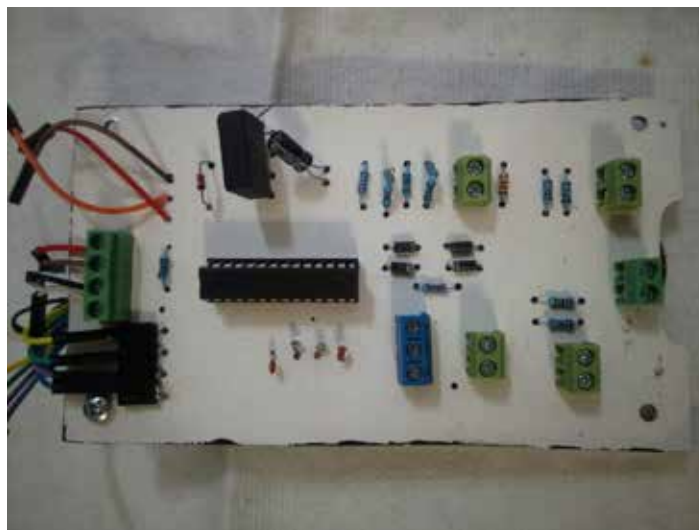
Figura 55. Montaje de los componentes en la baquelita Fuente: Leung y Sandoval (2017)
