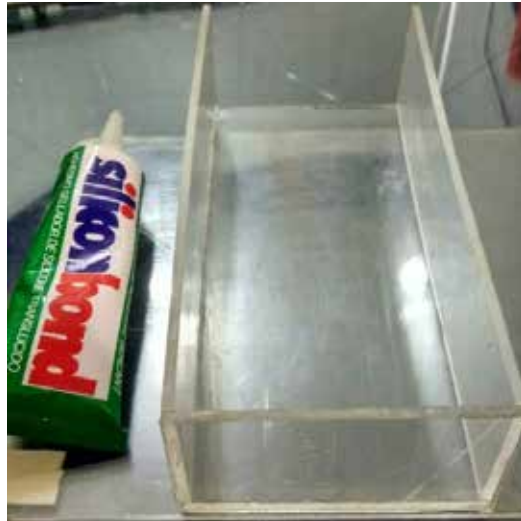
Figura 58. Etapa de pegar las láminas de acrílico
