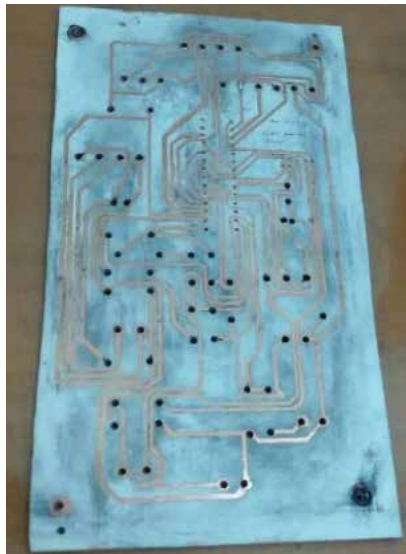
Figura 53. Circuito impreso en la baquelita
