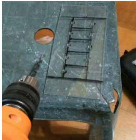
Figura 59. Etapa de perforación de los orificios de las borneras
