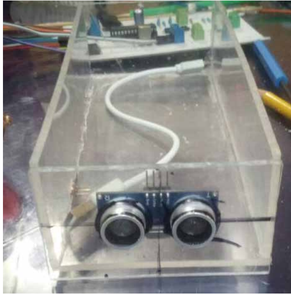
Figura 62. Etapa de empotrar el sensor de distancia Fuente: Leung y Sandoval (2017)
