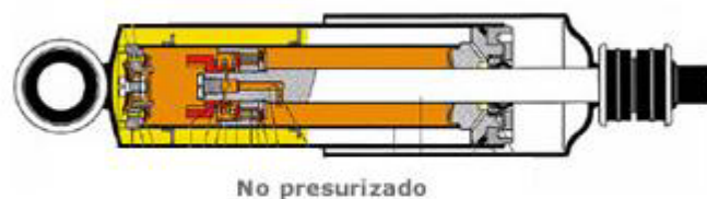
Figura 17. Amortiguador no presurizado.
