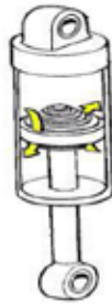
Figura 9. Flujo de aceite a través de las válvulas de apertura por presión. Fuente: https://ingemecanica.com/tutorialsemanal/tutorialn73.html
