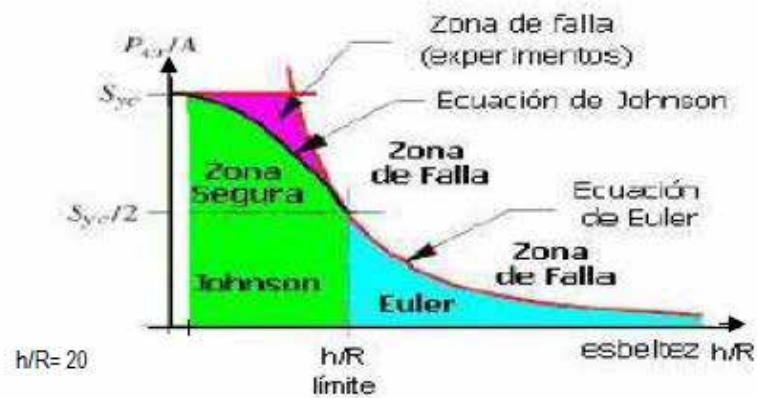
Figura 40: Representación de los criterios de Euler y de Johnson para elementos de máquinas largos sometidos a compresión
