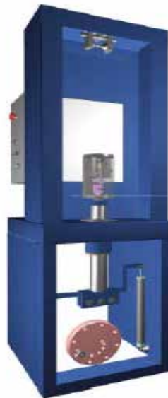
Figura 22: Bancos de ensayos electromecánicos Fuente: Ruiz C. (2012)
