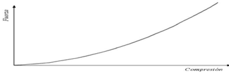
Figura 49: Resistencia de un retenedor de goma a ser comprimido
