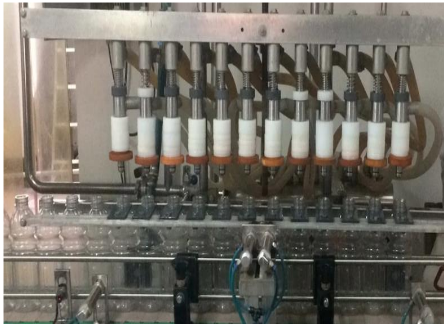
Figura 13 Máquina propuesta para el proceso de llenado de los envases Autores: Álvarez, R. y Rosales, C. (2023).
