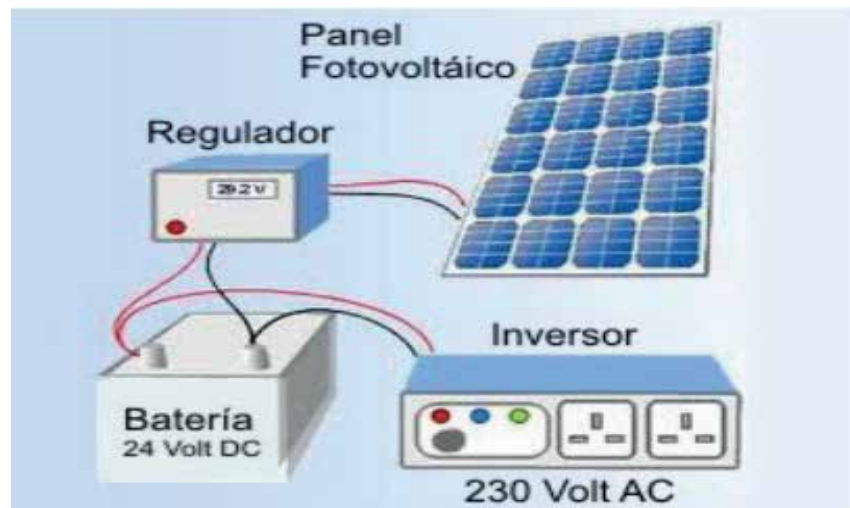
Figura 9. Elementos de un sistema fotovoltaico.9
