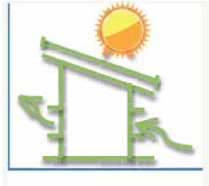
Figura 10. Ventilación cruzada en celosías de paredes 10
