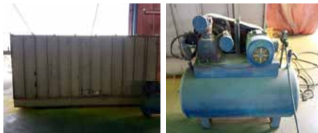
Figura 17: Cabina de Pintura y compresor General Electric de 5hp.
