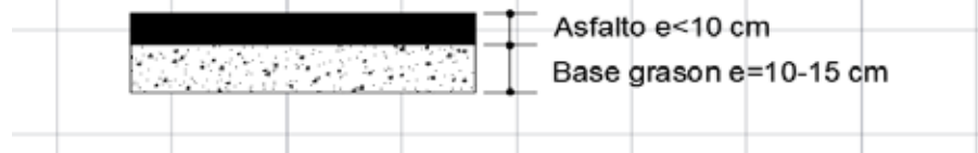
Figura 57: Sección del diseño de pavimento
