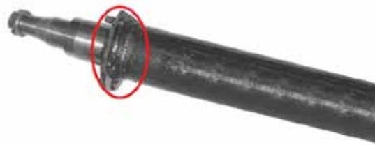
Figura 28. Eje principal soldado a la punta de eje Fuente: Catálogo de Carga Fácil (1.992)
