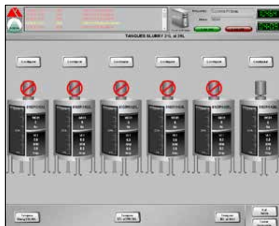
Figura 23. Ventana Tanques Slurry de Planta Latex
