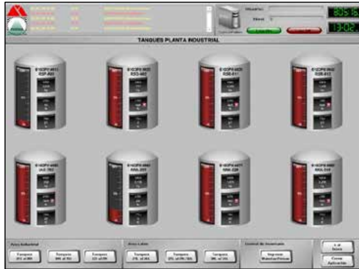
Figura 16. Ventana de Tanques de la Pantalla de Materia Prima
