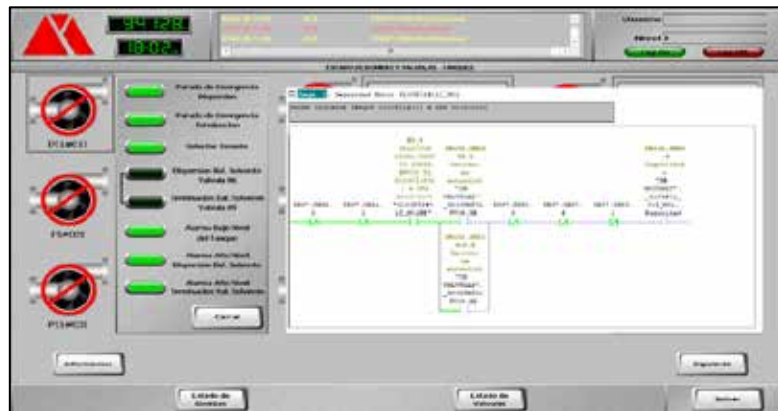
Figura 55. Ventana Indicadora de Señales de Seguridad de Cada Motor
