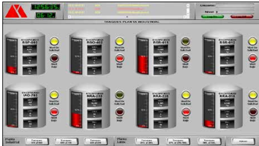
Figura 41. Tanques de la pantalla de Materia Prima
