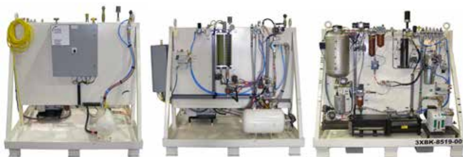
Figura 10 Máquina de llenado aceite de dirección, Máquina de llenado de refrigerante y Máquina refrigerante PCU radiadores.
