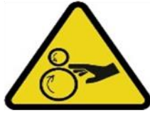
Figura 14: Etiqueta de Riesgo de Atrapamiento por Bombas.
