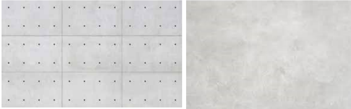
Figura 46. Láminas de concreto arquitectónico y concreto pulido. La Autora (2020)
