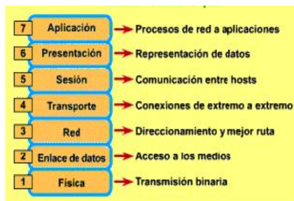
Figura 11: Capas del modelo OSI
