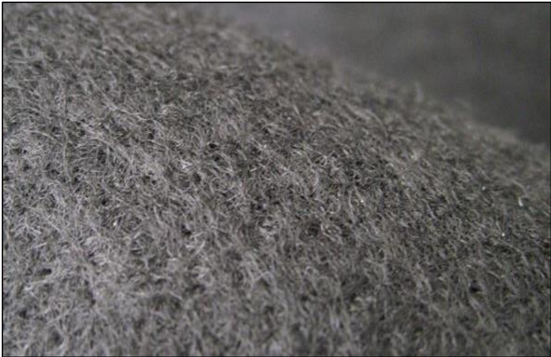
Figura 10: Vista macroscópica de geotextiles no tejidos.
