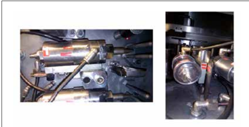
Figura 18. Marcas de ajuste estándar de las pistolas de pega. Fuente: Camacho y Ríos (2017).
