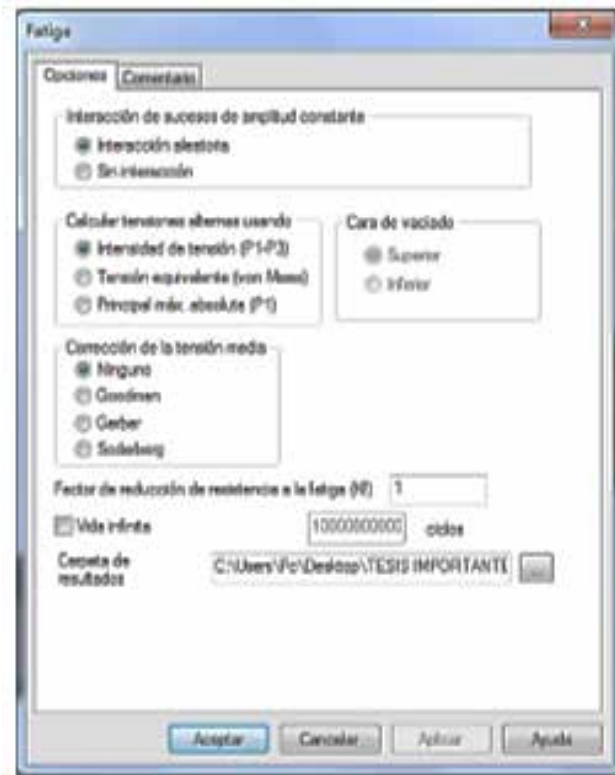
Figura 28: Selección del método de cálculo y factor reducción de resistencia a fatiga.
