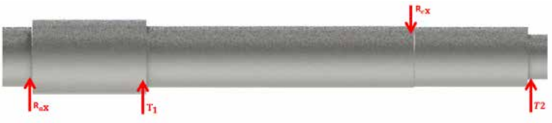
Figura 60. Diagrama de cuerpo libre Plano X-Z del Eje Caso 3
