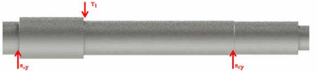
Figura 59. Diagrama de cuerpo libre Plano Y-Z del Eje Caso 3
