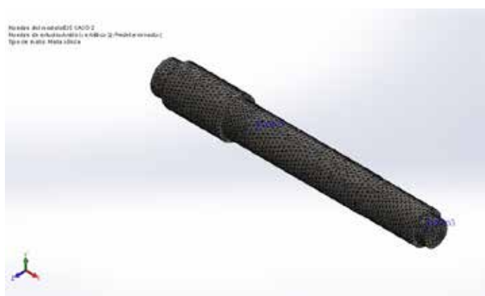
Figura 68. Mallado del eje caso 3 (44149 elementos)
