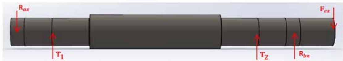
Figura 45. Diagrama de cuerpo libre Plano X-Z del Eje Caso 2.
