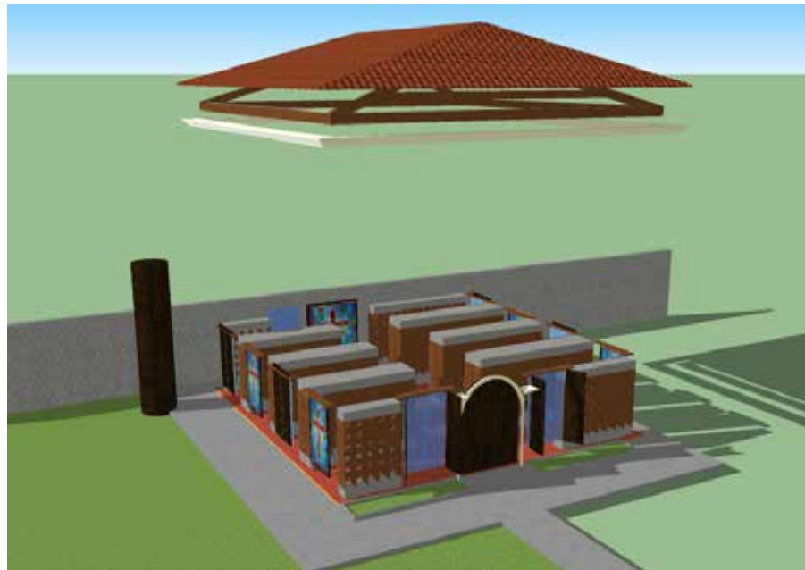
Anexo 2: Columbarios propuestos, despiece con vista interna.
