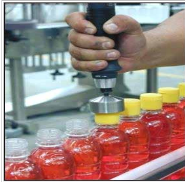
Figura 17. Tapadora de enroscado manual neumático con control de torque Fuente: Proveedor Equitek, S.A. (2017)
