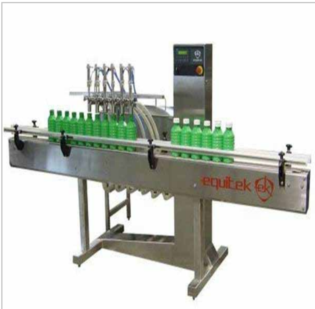
Figura 16. Máquina envasadora de líquidos corrosivos de baja y alta viscosidad
