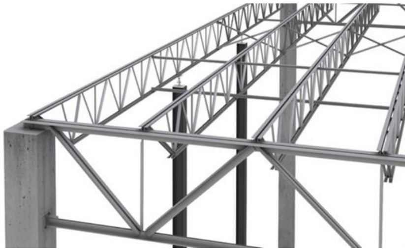
Figura 46: Detalle de cerchas (2018)
