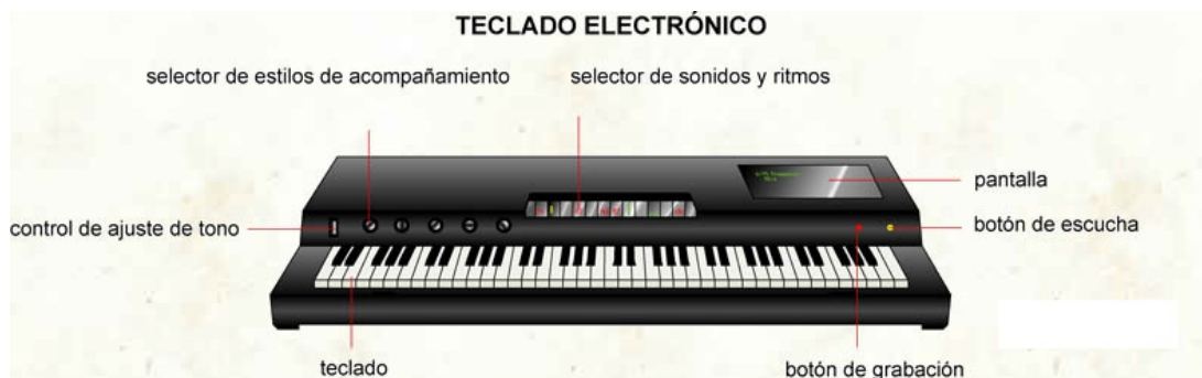
Figura 2: Partes de un teclado electrónico.
