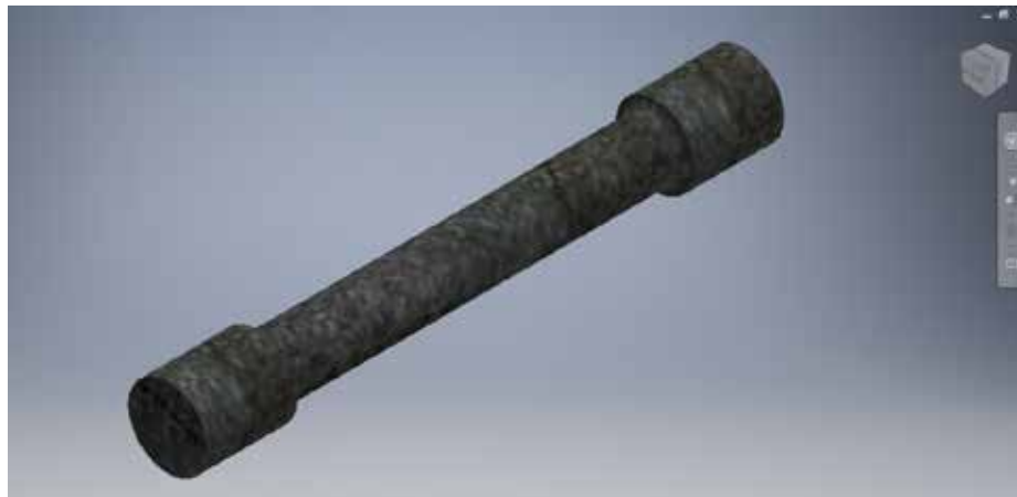
Figura 12: Vista en isometría de probeta de área transversal circular
