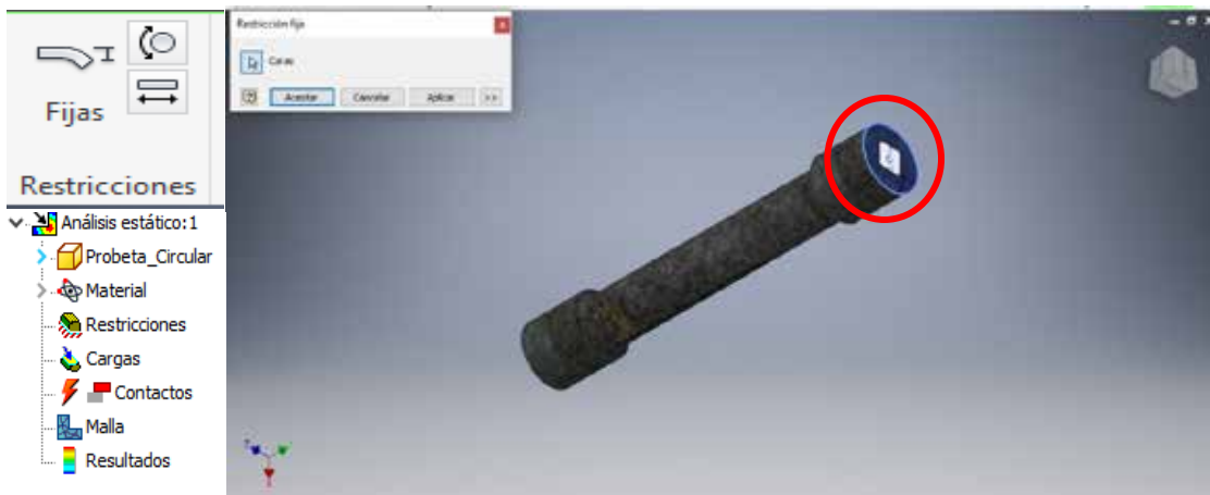
Figura B2.5: Aplicación de restricción fija
