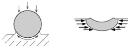
Figura 8: Proceso de deformación por shot pennig y volumen de esfuerzos residuales.
