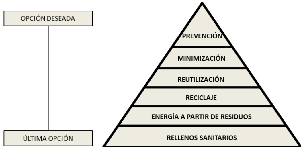
Figura 5. Jerarquía de los procedimientos a realizar en la gestión y tratamiento de residuos
