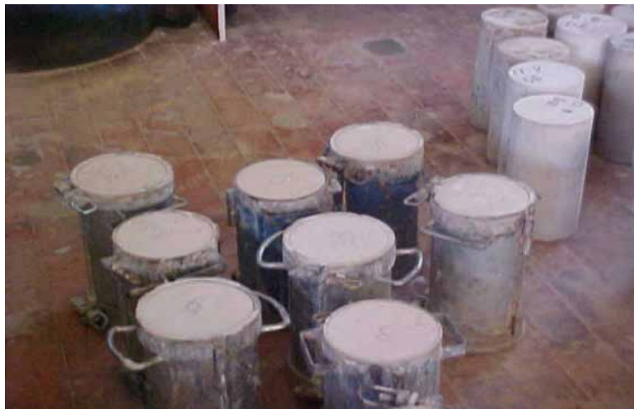
Figura: Cilindros de prueba de concreto con aserrín.
