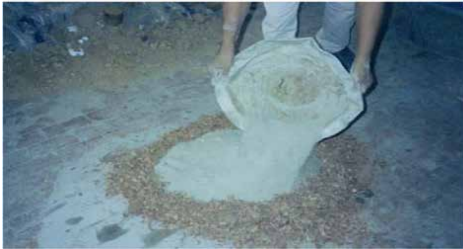
Figura: Amasado de agregados para prueba de concreto con aserrín.
