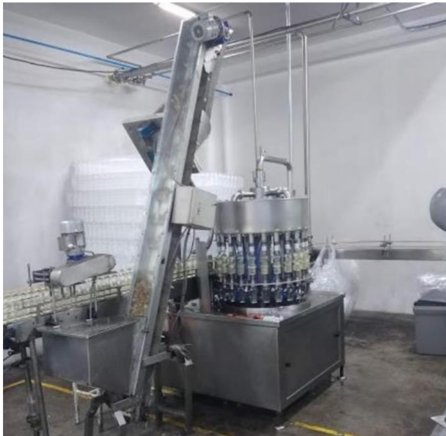
Figura 1: Línea de producción de envasado de aceite comestible.
