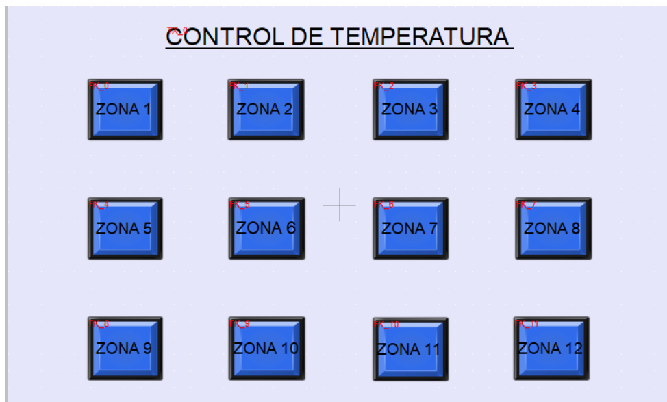
Figura 74. Pantalla principal del HMI del proceso
