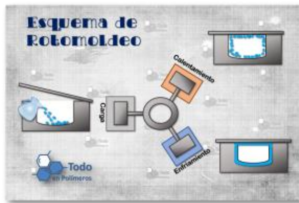
Figura 22. Esquema de Rotomoldeo
