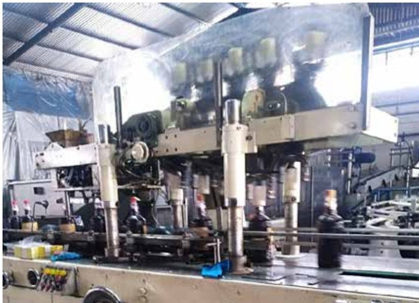
Figura 8. Proceso de la estampilladora, ubicada en la Planta de Envasado de Industrias El Carmen C.A.
