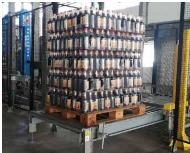
Figura 11. Operación final de la etapa del Paletizador.
