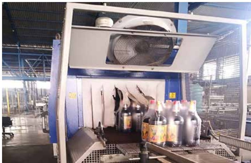
Figura 10. Proceso empaquetado con la termoencogible, ubicada en la Planta de envasado de Industrias El Carmen C.A.
