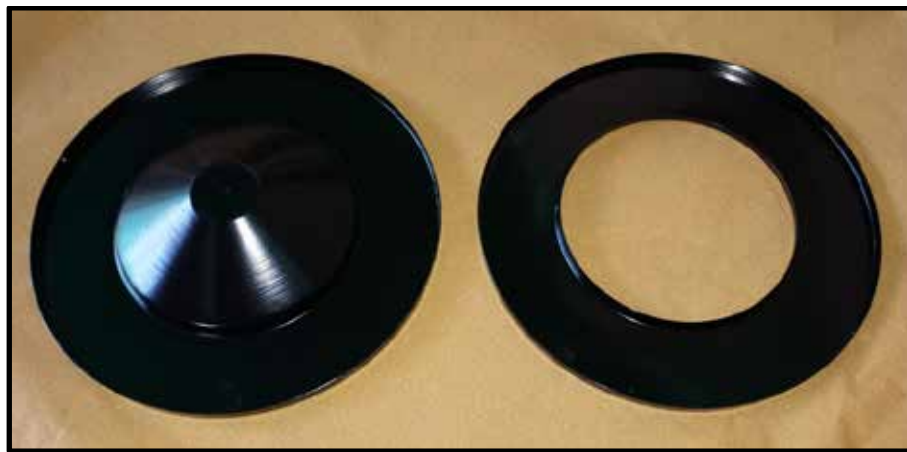
Figura 17. Piezas con pintura electrostatica, acabado final..
