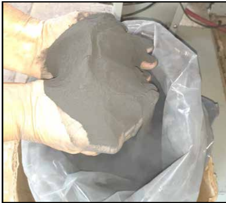
Figura 19. Pintura usada por segunda vez. Contaminada, desperdicio, si se usa nuevamente puede generar cambios de color, textura no deseada, grosor no deseado.
