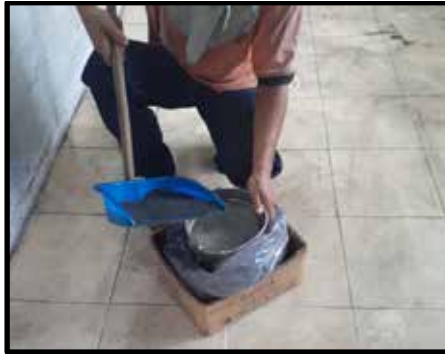
Figura 16. Recoleccion de la pintura no adherida precipitada en el piso de la cabina de pintura.
