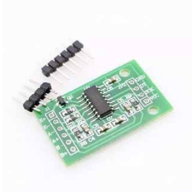
Figura 14. Módulo ADC HX711. Fuente: Tecnoconciencia C.A. (2019)
