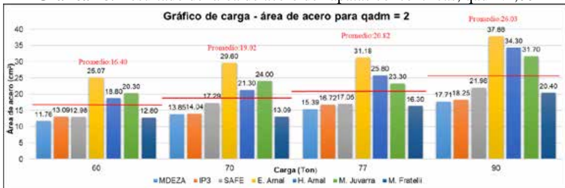
Gráfica 18. Resultado del área de acero de zapatas concéntricas, qadm:2,00
