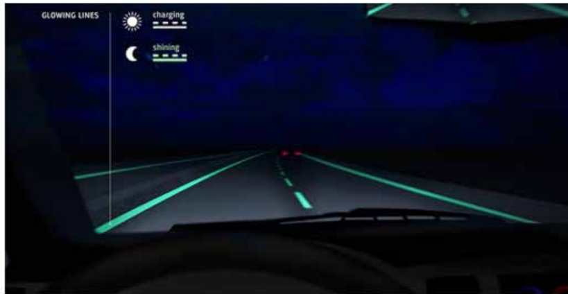
Figura 121: Demarcación con pintura fotoluminiscente.
