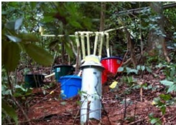
Figura 7. Descarga en pluviógrafo
