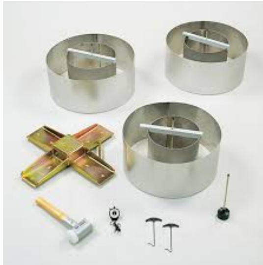
Figura 2. Infiltrómetro de doble anillo sin botella de Mariotte (Desarmado)
