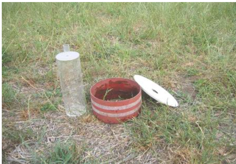
Figura 1. Infiltrómetro de anillo único con botella de Mariotte (Desarmado)
