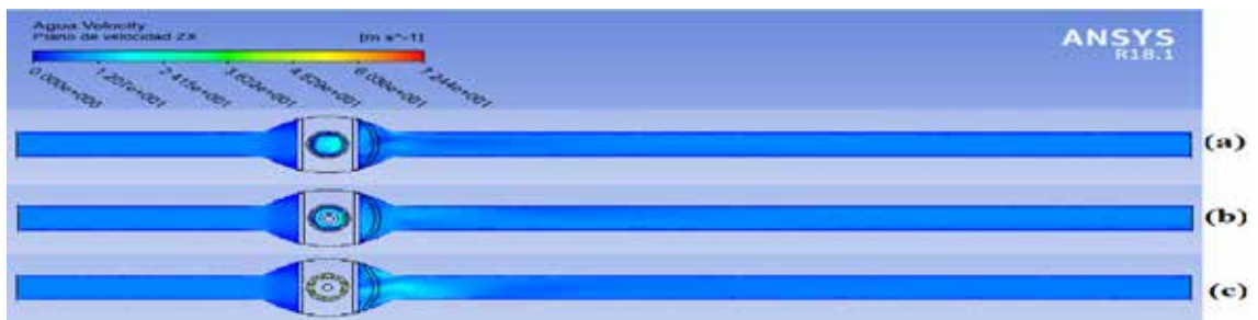
Figura 111. Velocidad sobre el plano XZ para aperturas de (a) 75%, (b) 50% y (c) 25%.
