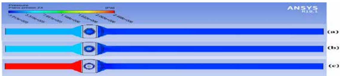
Figura 97. Presión sobre el plano XZ para aperturas de (a) 75%, (b) 50% y (c) 25%.
