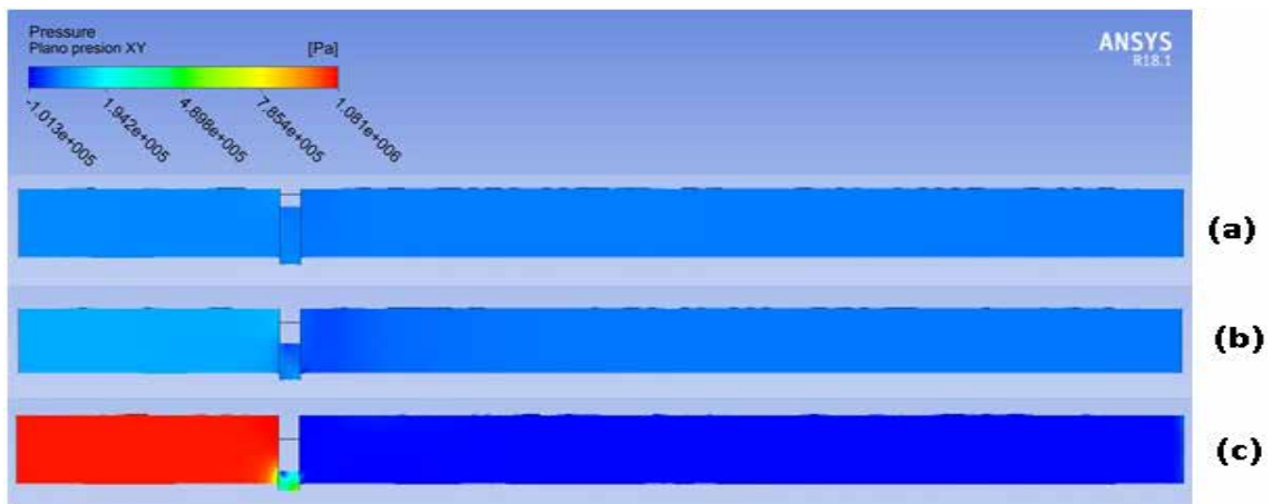
Figura 75. Presión sobre el plano XY para aperturas de (a) 75%, (b) 50% y (c) 25%.
