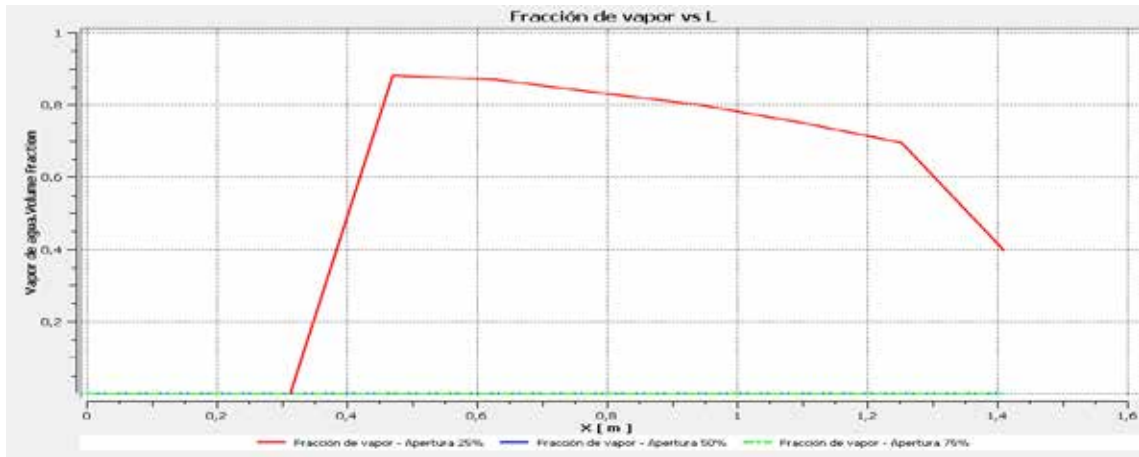
Gráfica 22. Fracción de Vapor vs Longitud (L) para aperturas de 25% (Rojo), 50% (Azul) y 75% (verde).
