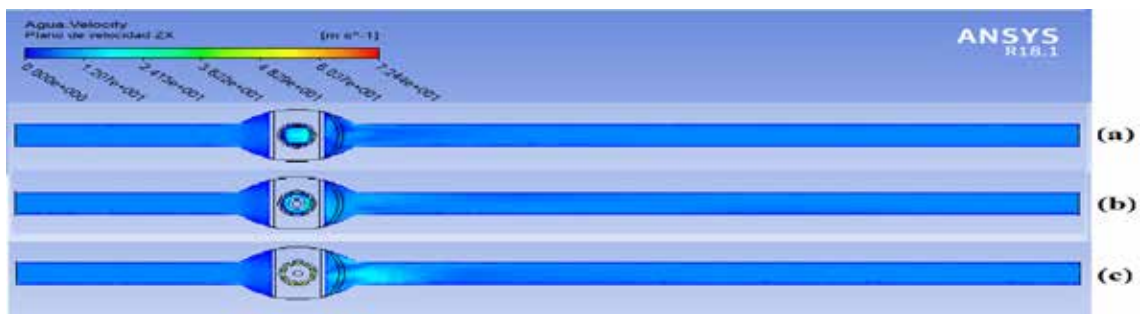
Figura 105. Velocidad sobre el plano XZ para aperturas de (a) 75%, (b) 50% y (c) 25%.
