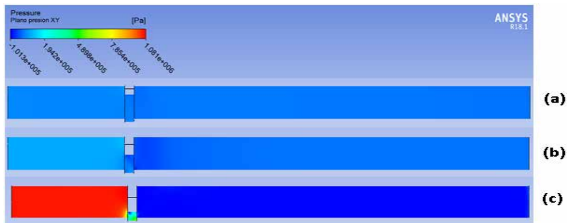
Figura 87. Presión sobre el plano XY para aperturas de (a) 75%, (b) 50% y (c) 25%.
