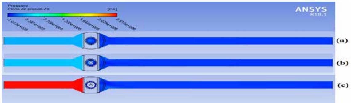
Figura 103. Presión sobre el plano XZ para aperturas de (a) 75%, (b) 50% y (c) 25%.
