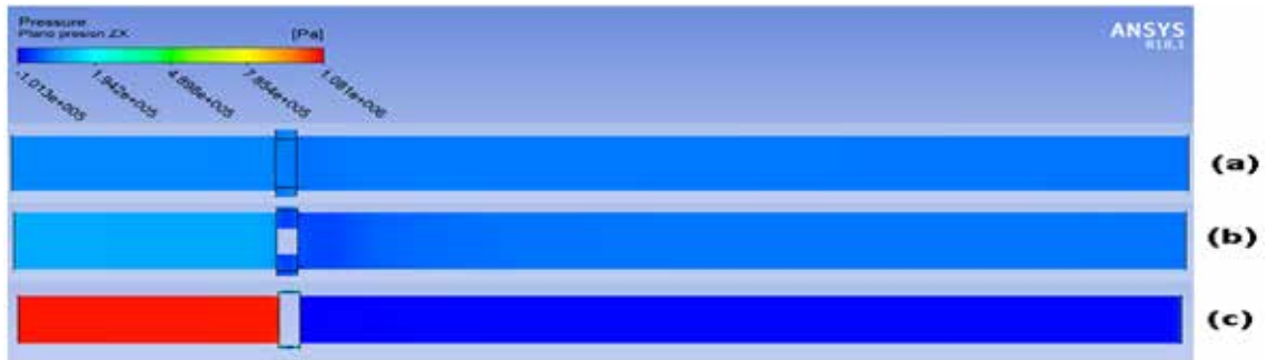
Figura 82. Presión sobre el plano XZ para aperturas de (a) 75%, (b) 50% y (c) 25%.
