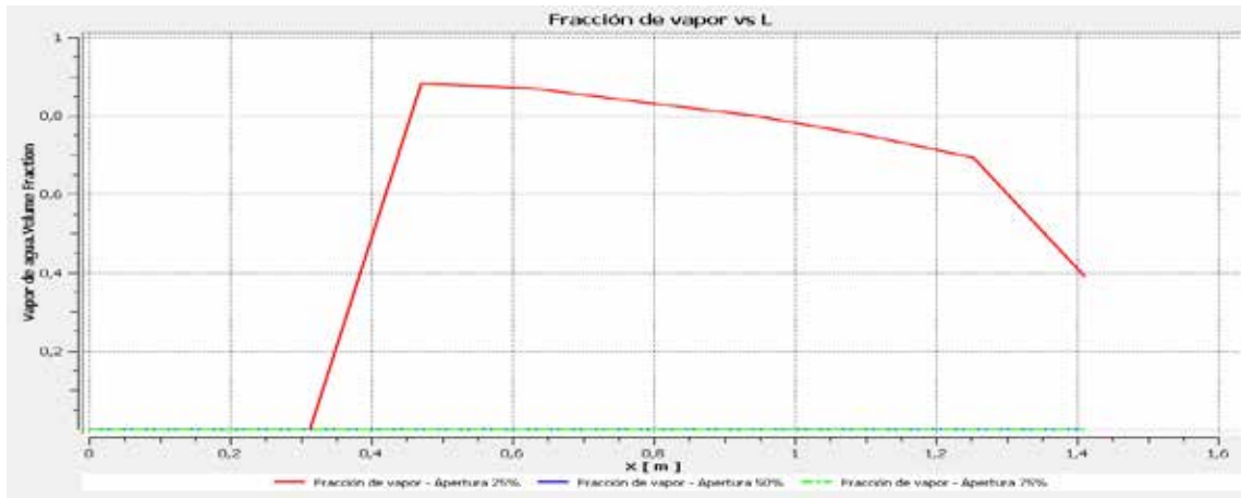
Gráfica 19. Fracción de Vapor vs Longitud (L) para aperturas de 25%(Rojo), 50%(Azul) y 75%(verde).
