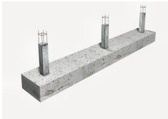
Figura 3. Fundaciones corridas o continuas Nota.
