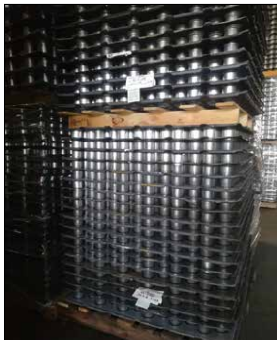
Figura 8: Vaso 47-71394 desprotegido. Mann+Hummel Filtration Technology Venezuela C.A (2018)
