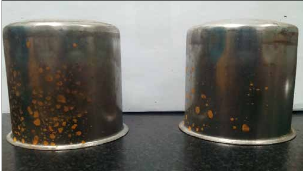
Figura 19: Vaso 47-71040 oxidado. Mann+Hummel Filtration Technology Venezuela C.A (2018)
