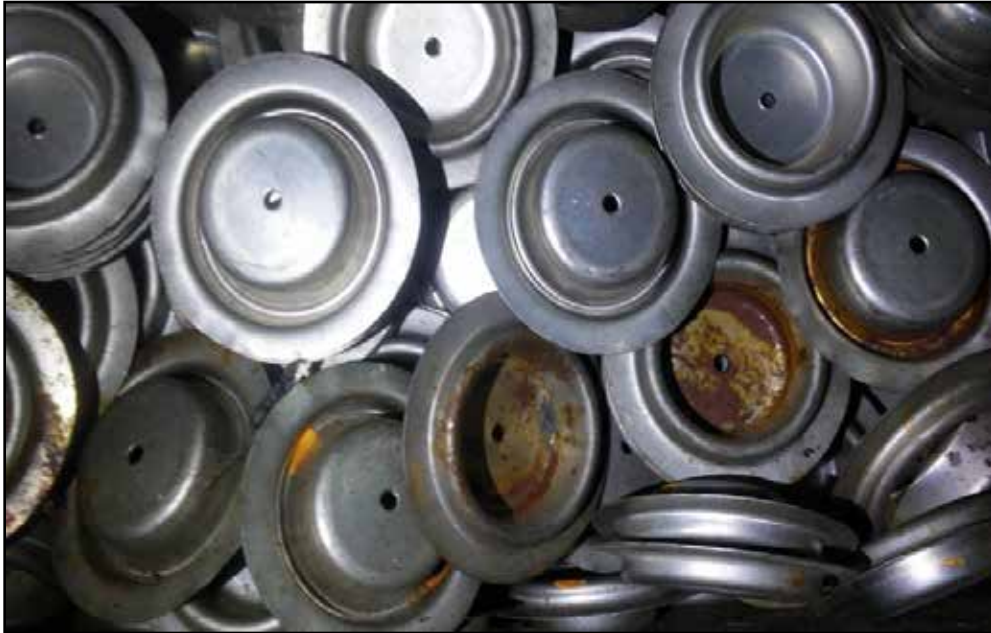
Figura 17: Espaciador metálico 31-04419 oxidado . Mann+Hummel Filtration Technology Venezuela C.A (2018)
