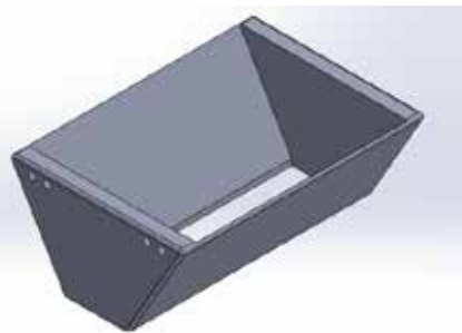
Figura 19: Tolva del molido existente
