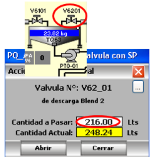
Imagen #13 Apertura de válvula y selección de cantidad de agua a pasar
