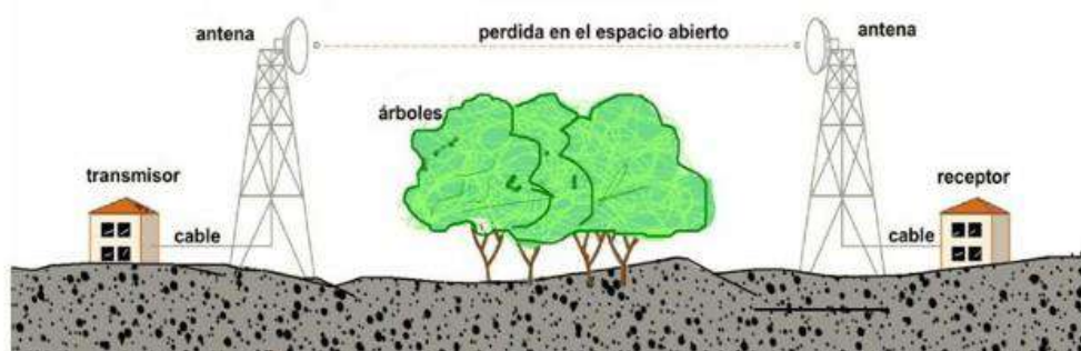
Figura 4. Esquema de un radioenlace.
