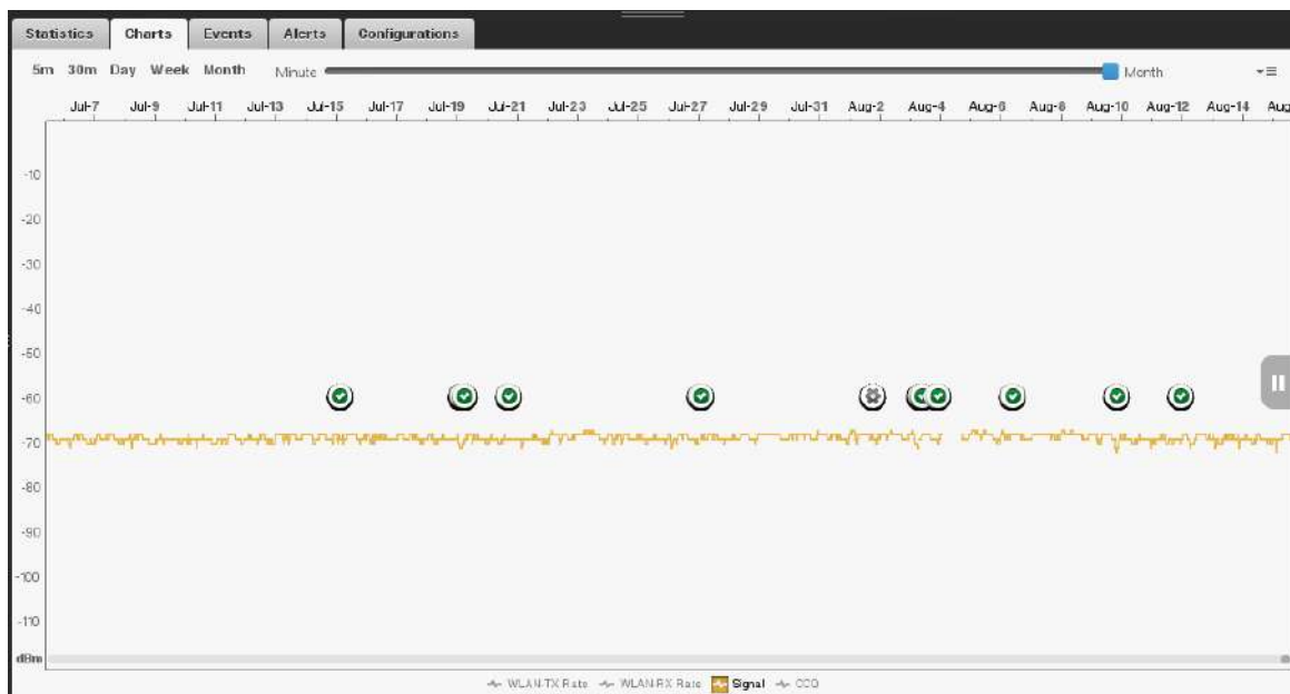
Figura 83. Potencia reciente del cliente 4 del sector #3, monitoreado con AirControl.
