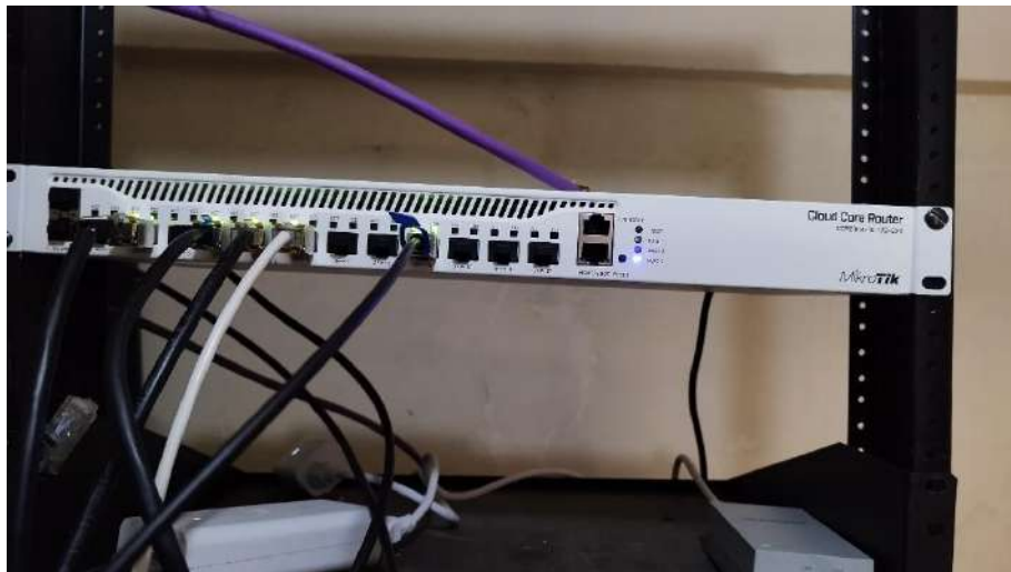
Figura 19. Router de la celda, marca Microtik, modelo CCR2004-1G-12S+2XS.
