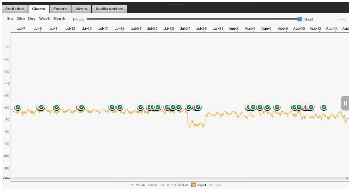
Figura 86. Potencia reciente del cliente 7 del sector #8, monitoreado con AirControl.
