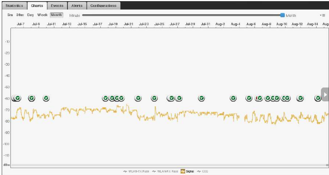
Figura 81. Potencia reciente del cliente 5 del sector #1, monitoreado con AirControl.
