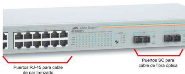
Figura 12. Fotografía de un switch, mostrando los puertos RJ-45 y SC.
