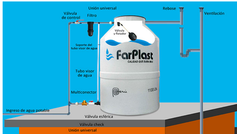
Figura 26: Tanque de agua. Fuente: http://farplast.pe/wp-content/uploads/2016/06/instalacion-tanque-para-agua-farplast.jpg
