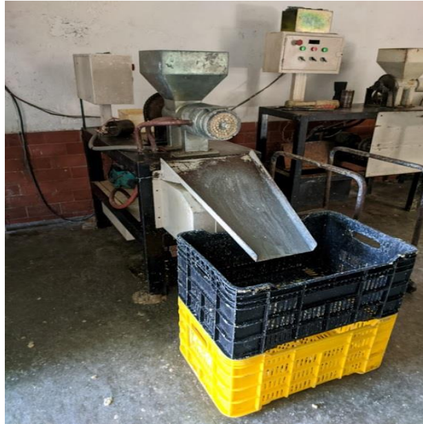
Figura 14 Ilustración 7 PROCESO DE EXTRACTORA CON CAMISA DE AGUA. SIN TROMPA.
