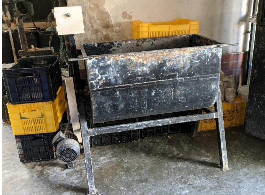
Figura 10 Ilustración 4 PROCESO DE MEZCLADO # 1 (SODA, ACEITE Y AGUA) Fuente: Bioproductos Venezolanos, C.A. (2021)
