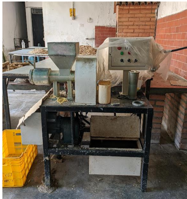
Figura 15 Ilustración 8 PROCESO DE EXTRACTORA CON RESISTENCIA. VIRUTA CALIENTE.
