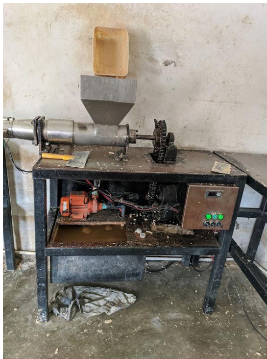
Figura 17 Ilustración 9 LUEGO EN LA EXTRUSORA SE HACE LA BARRA. Fuente: Bioproductos Venezolanos, C.A. (2021)
