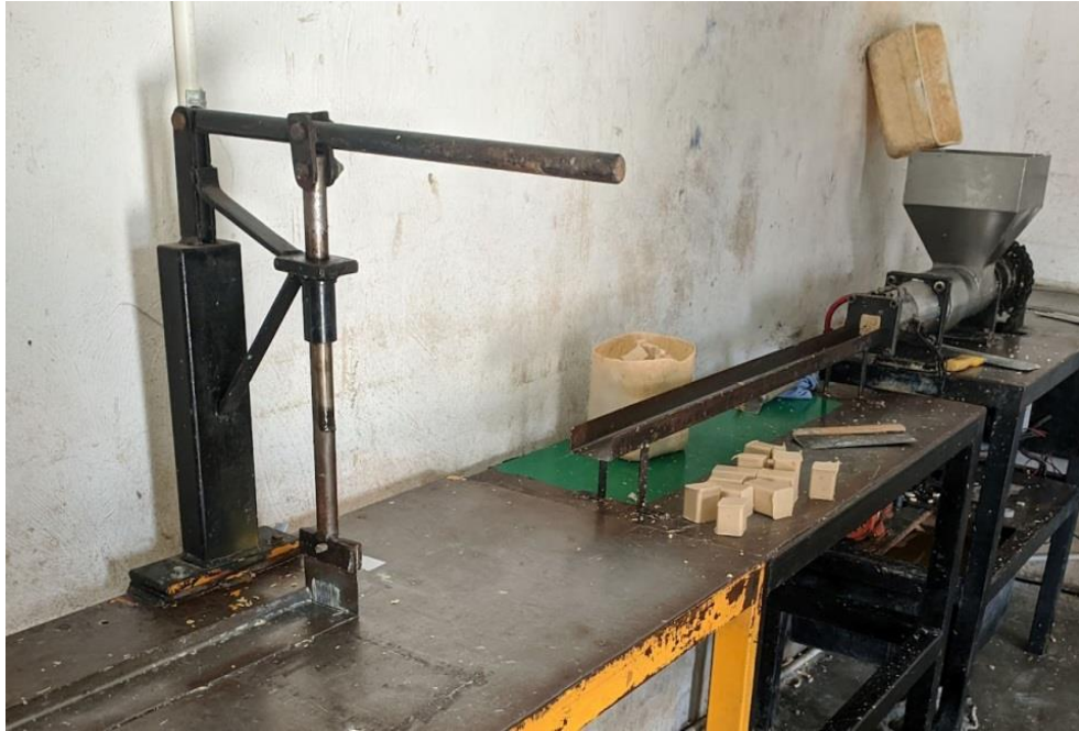
Figura 18 Ilustración 10 PROCESO DE CORTE EN MÁQUINA PICADORA. Fuente: Bioproductos Venezolanos, C.A. (2021)
